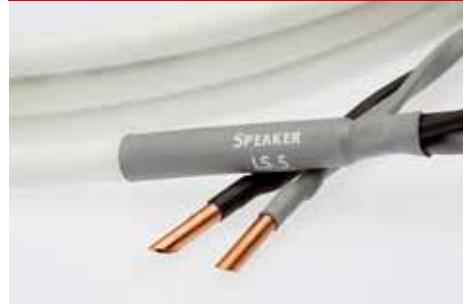
Die Innenleiter des LS5-Lautsprecherkabels bestehen aus einzelnen, verdrehten Adern. Dies bringt Vorteile für Klang, Störsicherheit und Flexibilität des Kabels.
